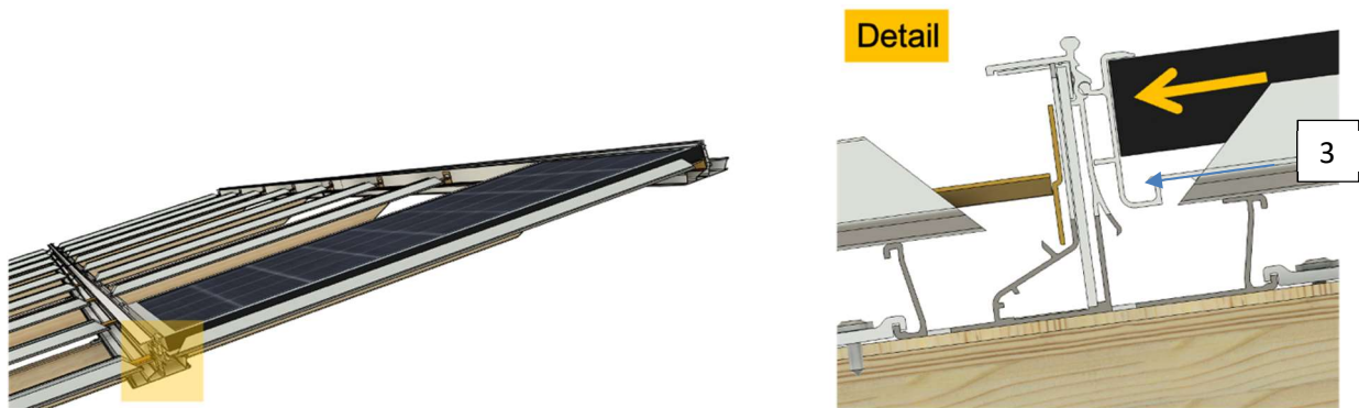
Abbildung - 29 : Ablauf Einlegen des PV-Moduls 2.
