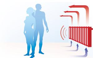
*Konventionelle Heizung: Vor allem Erwärmung der Luft. Dadurch starke Luftbewegung (Konvektion).*
